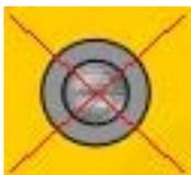
Перечеркнутый красным крестиком символ означает, что аттракцион заблокирован внешним устройством (например, противоток заблокирован от включения при закрытом сматывающем укрытии).
