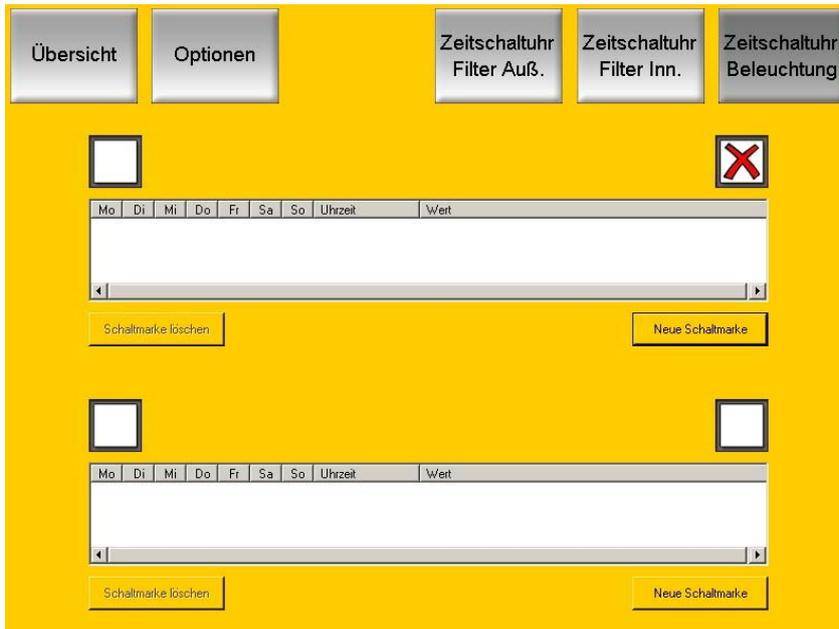
Если таймер остановлен, то с помощью белой кнопки справа можно вручную включать и выключать подводное освещение.
